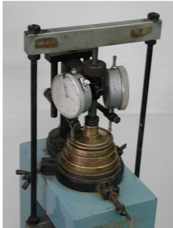
Rys. 2 Edometr – metalowy pierścień z ustawionymi czujnikami
