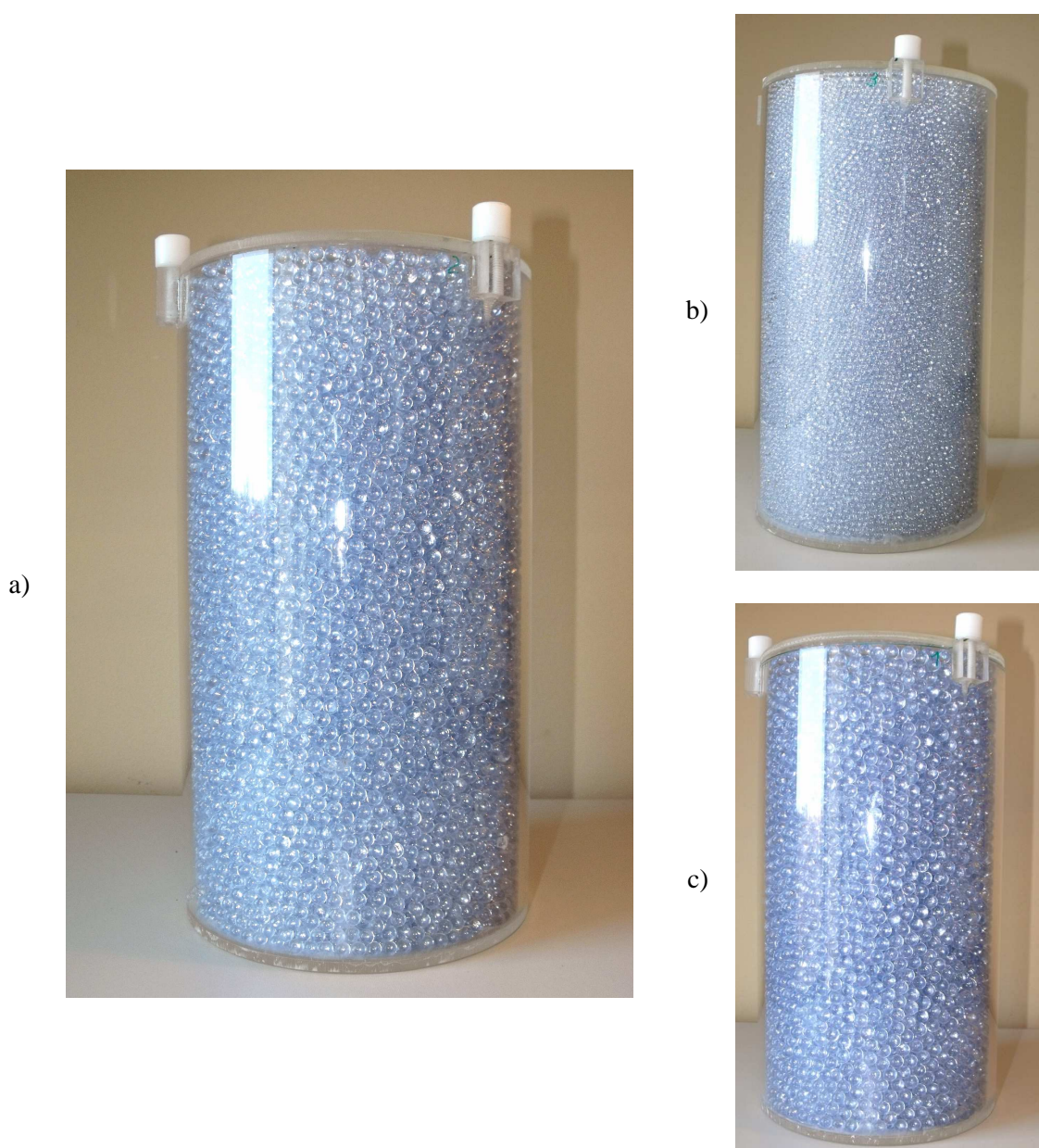
Rys. 4.1. Materiał badawczy – kulki szklane o średnicach 6 (a), 4 (b) i 8 (c) [mm] umieszczone w cylindrach pleksyglasowych o średnicy 150 [mm]
