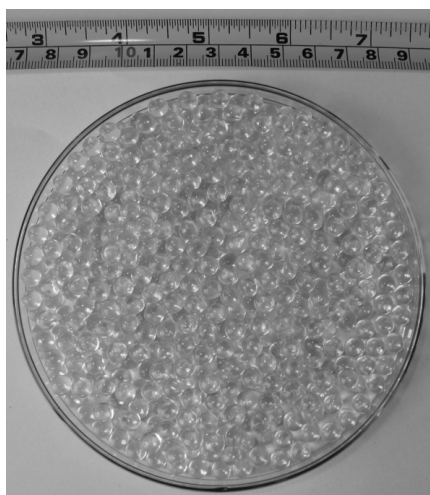
Rys. 2.1. Materiał granularny – kulki szklane o średnicy 6 [mm]
