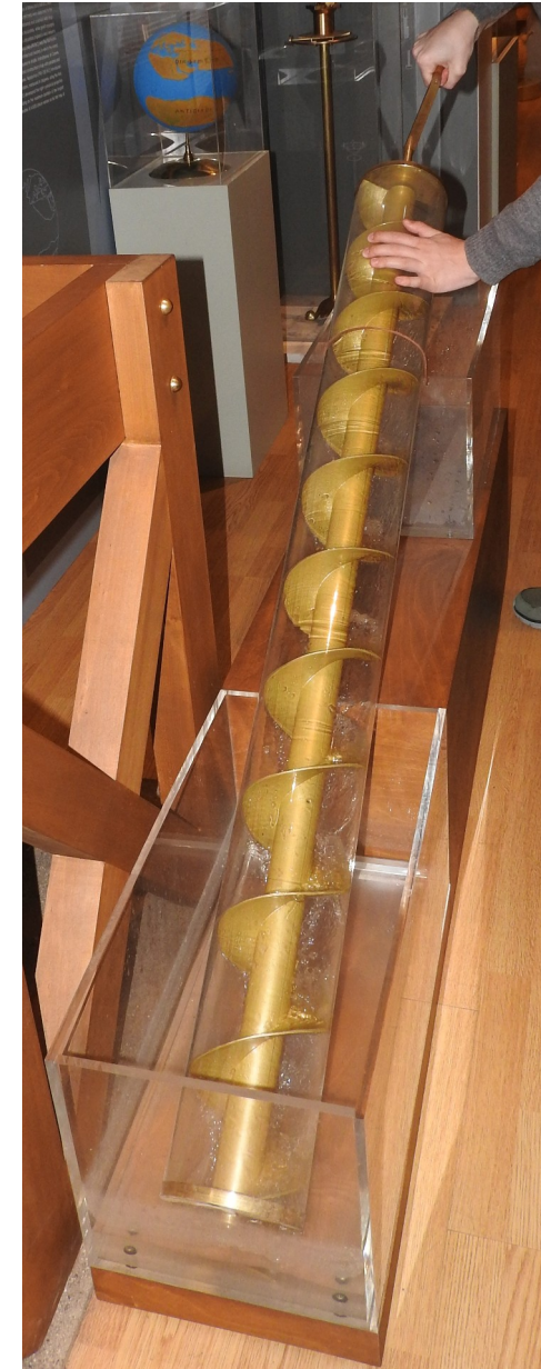
przykłady starożytnej techniki – śruba Archimedes (wynałazek z Babilonii)
